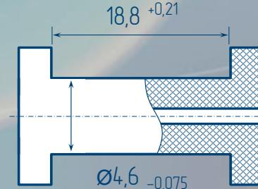
5000 витков, провод Ø 0,063 мм
