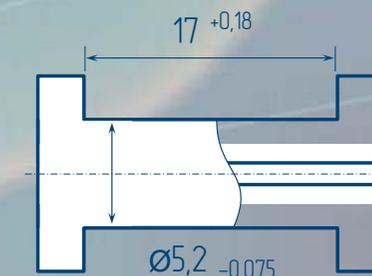
5000 витков, провод  $\varnothing$  0,08 мм
