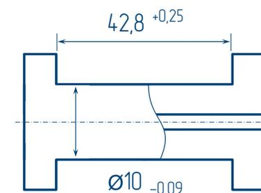
5000 витков, провод  $\varnothing$  0,112 мм
