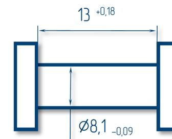
5000 витков, провод  $\varnothing$  0,063 мм
