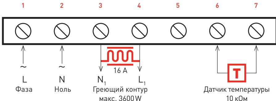
Подключите систему теплого пола к терморегулятору IQ THERMOSTAT после полно-го высыхания плиточного клея/цементно-песчаной стяжки в соответствии с реко-мендациями производителя.
