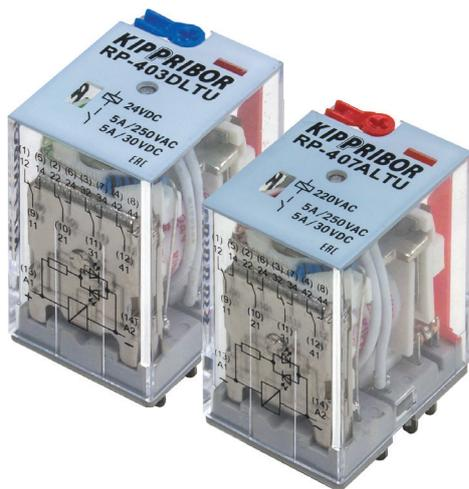
Имеют обновленный дизайн корпуса, позволяющий четко идентифицировать модификацию реле при групповом монтаже. Используются в качестве развязывающего (согласующего) элемента между управляющим устройством (терморегулятором, контроллером и пр.) и коммутационным элементом исполнительного устройства, а также для построения схем релейной логики.
