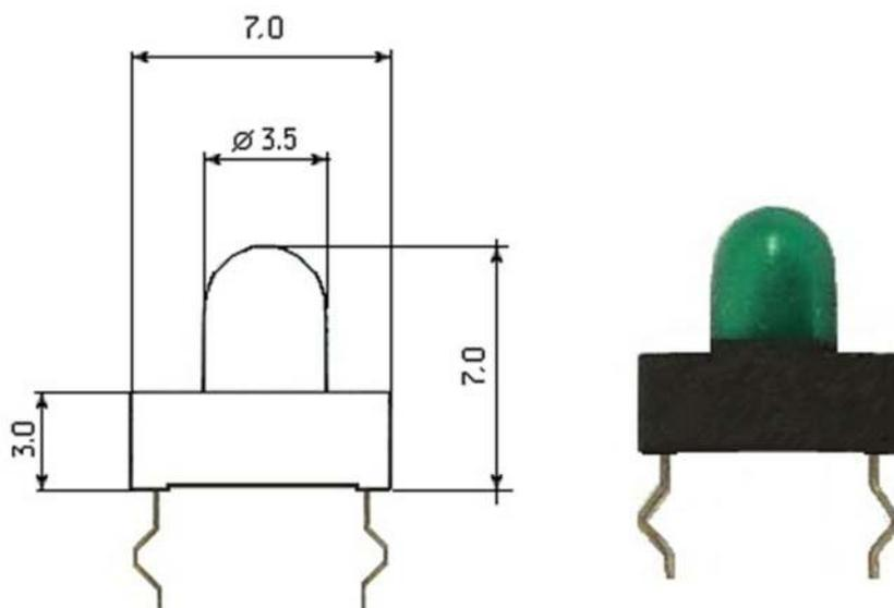
Лампы используются в качестве индикаторов и для подсветки в различной аппаратуре. Выпускаются различные цвета ламп и на различные напряжения.
