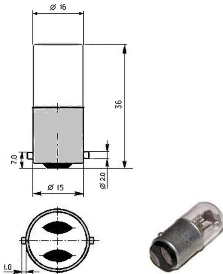
Лампа предназначена для применения в головных и ручных аккумуляторных светильниках индивидуального освещения в горно-рудной промышленности. Лампа отличается высоким качеством и надежностью.
