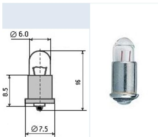
Миниатюрная лампа накаливания применяется для освещения и подсветки шкал радиоэлектронных приборов, сигнализации, в карманных, портативных и батарейных фонарях
